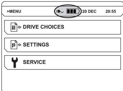
Si la batterie est retirée pendant que la télécommande est reliée au câble CAN, le symbole de batterie sur la télécommande sera barré pour indiquer qu'aucune batterie n'est disponible.
