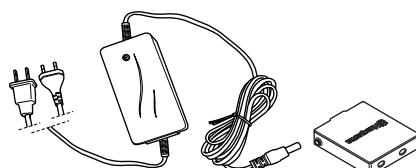
Le temps de chargement d'une batterie à plat est d'environ 2-3 heures. La diode est orange lorsque le chargement démarre et devient verte lorsque la batterie est pleine. Lorsque la batterie est pleine, le chargeur envoie à la batterie un courant de service jusqu'à ce qu'il soit débranché.
