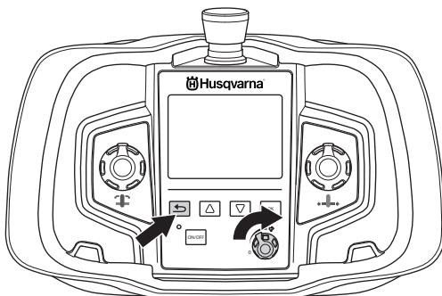
Si la valve d'eau est réglée sur « AUTO », un délai de 3 secondes s'écoule avant le début de la rotation de la lame. Le décalage permet au groupe moteur de refroidir ; il peut en effet devenir extrêmement chaud quand il est actif et quand il n'y a pas de circulation d'eau de refroidissement.
