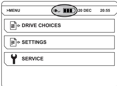
Si se desmonta la batería mientras el control remoto está conectado al cable CAN, el símbolo de batería del control remoto aparecerá tachado para indicar que no hay batería.
