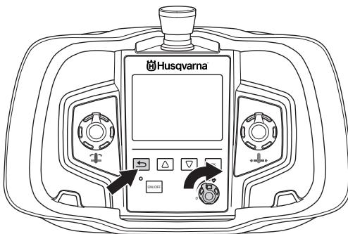
Befindet sich das Wasserventil in der Einstellung „AUTO“, startet die Trennscheibendrehung mit einer Verzögerung von 3 Sekunden. Die Verzögerung dient zur Abkühlung des Aggregats, da es heiß werden kann, wenn es in Betrieb ist und kein Kühlwasser zirkuliert.
