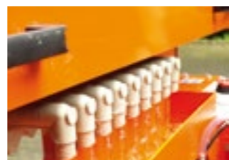
Filterausgang mit Ablaufrinne
