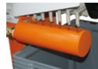
Filterausgang mit Ablaufrinne
