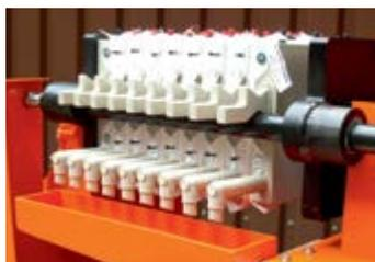
Unité filtre avec pompe à boue pneumatique SFP 8 L
