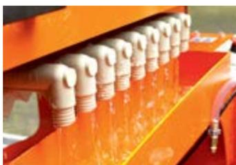
Sortie de filtre avec rigole de drainage SFP 8 L
