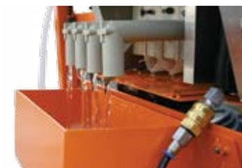
Sortie de filtre avec rigole de drainage SFP 3 L
